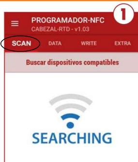
La pestaña **SCAN** permite la lectura de los datos ya grabados en el equipo y reconocerá el modelo de equipo que es de manera automática. La APP emite un pitido de notificación cuando a detectado el equipo y a descargado su programación.
