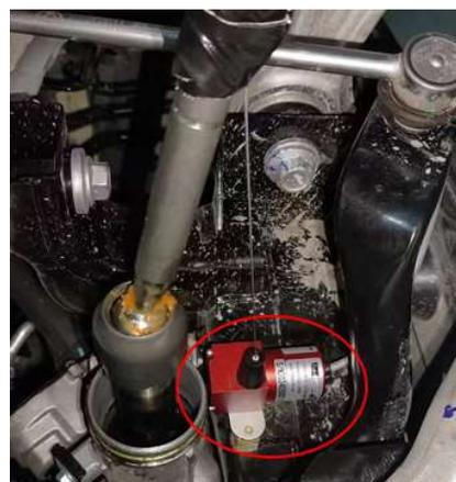
Un sensor de desplazamiento por hilo o sensor de desplazamiento por cable, basa su funcionamiento en la extracción de un cable de acero de un carrete para realizar la medida. Cuenta con tres partes fundamentales, cable de acero trenzado o hilo de nylon flexible, para realizar la medida, tambor para enrollar el cable, muelle de retorno y elemento sensor.
