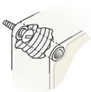
La caja no pierde su protección IP65 porque los tornillos de sujeción se encuentran fuera del recinto que contiene la electrónica.
